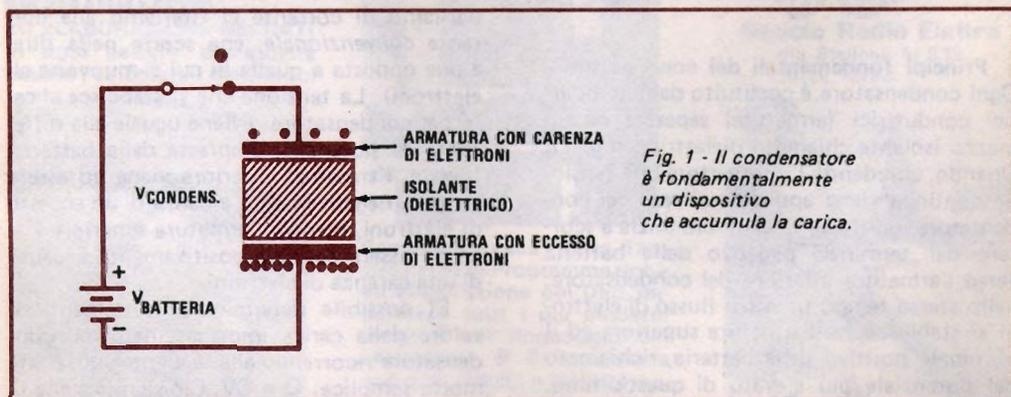
*Fig. 1 - Il condensatore è fondamentalmente un dispositivo che accumula la carica.*
